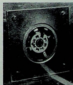
Bild 28. Schirmgitter-Klatschkondensator 51 und Ersatzsockel 50 A (oben) sowie Ersatzsockel 50 B (unten)
